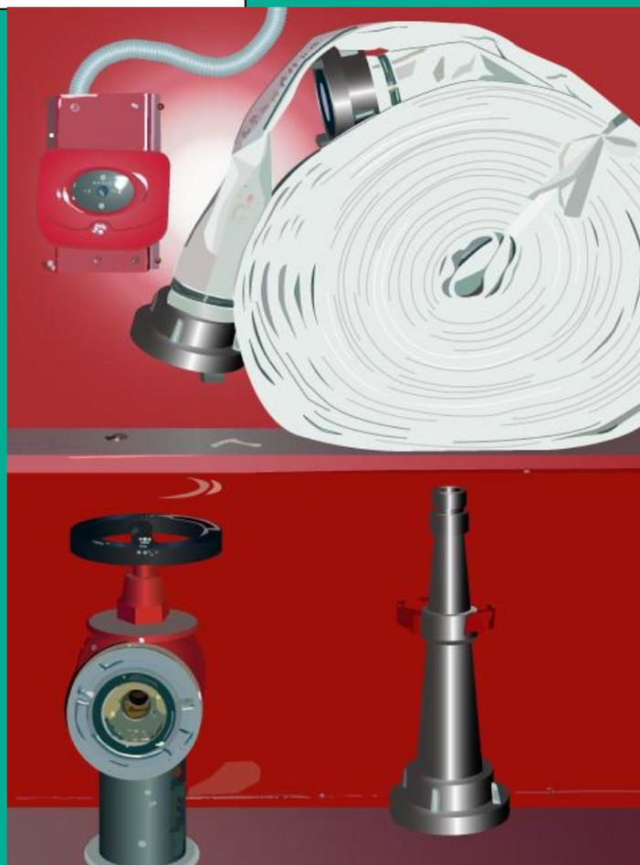
遇有火警，按下弹簧锁，拉开箱门，连接水枪与水带接口、水带与消火栓接口，如有加压泵，击碎加压泵启动按钮玻璃，将手轮逆时针旋开，即能喷水灭火。
